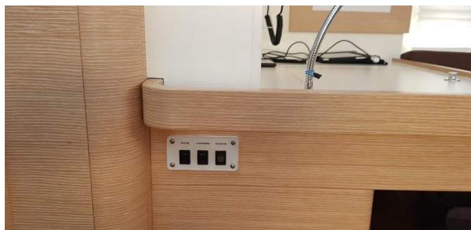
Zdjęcie 19. Umieszczenie wyłączników elektrycznych z boku stołu nawigacyjnego (inwerter jest wyłączony – wciśnięta górna część wyłącznika)
