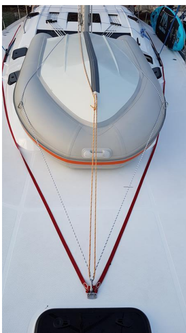
Zdjęcie 4. Mocowanie i przygotowanie do slipowania pontonu
