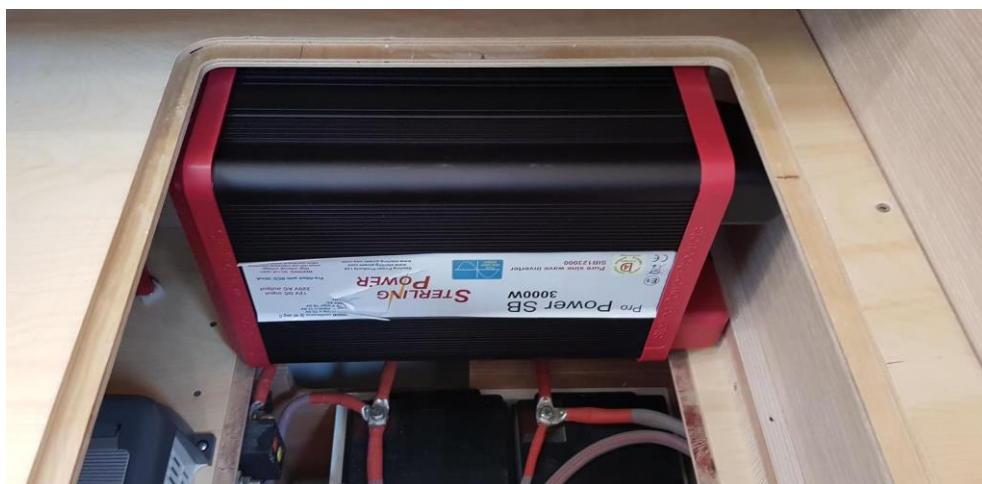
Zdjęcie 16. Prostownik (po lewej) i inwerter (po prawej) pod siedziskiem nawigacyjnym
