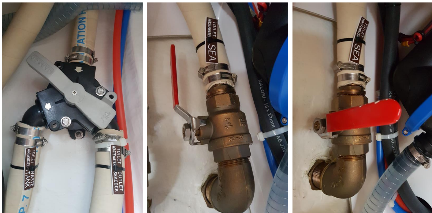
Zdjęcie 21. Trójnik w WC dziobowym i rufowym lewym w pozycji „zamknięty” (z lewej), zawór w WC rufowym prawym w pozycji „otwarty” (środkowy) oraz o „zamknięty” (po prawej)
