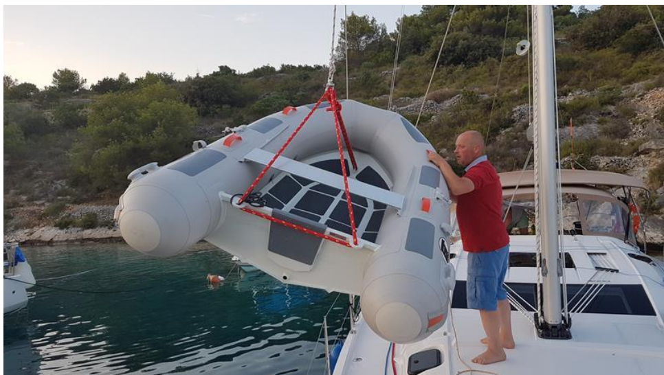
Zdjęcie 5. Slipowanie pontonu w pozycji: pionowej i poziomej
