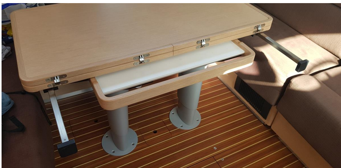
Zdjęcie 10. Wsporniki pod rozkładane skrzydło stołu i klamki do jego opuszczania i podnoszenia
