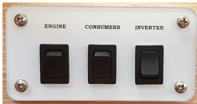
Zdjęcie 19. Umieszczenie wyłączników elektrycznych z boku stołu nawigacyjnego (inwerter jest wyłączony – wciśnięta górna część wyłącznika)
