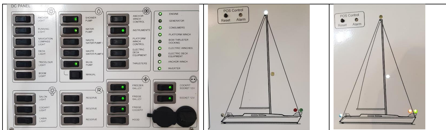
Zdjęcie 15. Panel 12 V i schemat oświetlenia nawigacyjnego (kotwiczne i dalej silnikowe jachtu w drodze)
